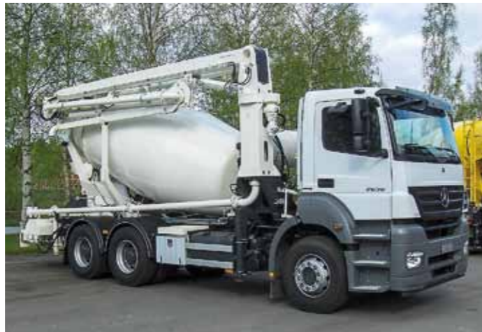
Kolmiakseliselle, kokonaismassaltaan 28 tonnin alustalle asennettu Saraka City M17-3Z-4" -yhdistelmäpumpu tarjoaa noin kuuden kuution hyötykuorman.
